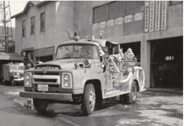
水槽付消防ポンプ自動車（当別）
