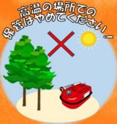
直射日光の当たる場所や高温の場所にガソリン缶を置くと、可燃性ガスが膨張し、蒸気が大量に噴き出し、引火する可能性があります。
