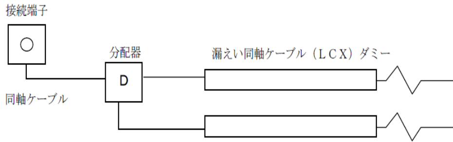
第 23-1 図 漏えい同軸ケーブル方式
